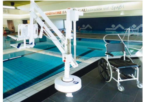
Badrollstuhl und Schwimmbadlifter im Hallenbad
